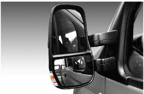
Kính hậu chỉnh điện kết hợp với hệ thống sưởi, đảm bảo tầm nhìn tối đa trong điều kiện thời tiết khắc nghiệt.
