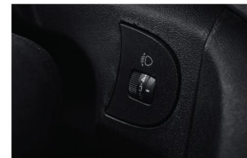
Hệ thống đèn chiếu sáng được trang bị công tắc điều chỉnh góc chiếu.
