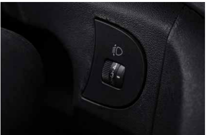
Hệ thống đèn chiếu sáng được trang bị công tắc điều chỉnh góc chiếu.
